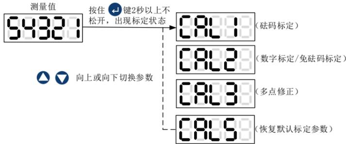
**CAL1: 砝码标定**—采用实物标定的方法。零点标定时传感器空载,增益标定时加载实物测量满量程。
