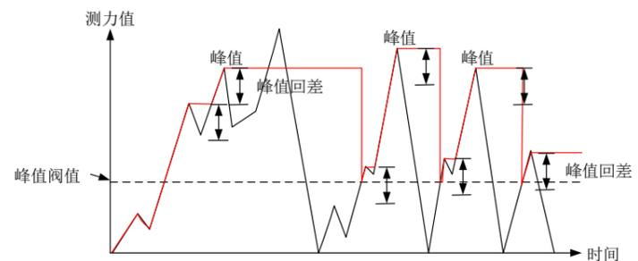
如上图所示, 当测量值超过峰值阈值设定值后, 仪表开始检测峰值; 当测量值回落幅度超过峰值回差设定值后, 锁存当前检测到的峰值, 测量值低于阈值后停止检测, 获取到峰值。
