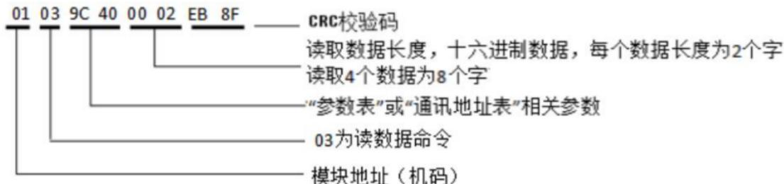
发送: nn 03 06 06 00 02 crc0 crc1 读取测量值(整型数)
